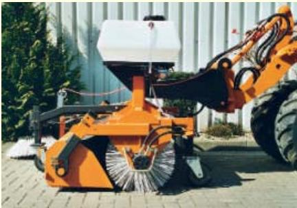
**bema 20** с адаптером на садовый погрузчик, системой орошения 240 л, гидравлической боковой щёткой, усиленными колесами.
