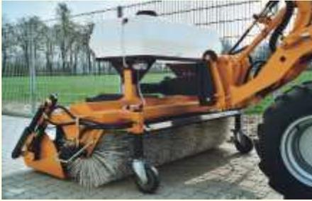
**bema 25**, укомплектованная быстросменным адаптером на колёсный погрузчик, системой орошения 240 л, боковой щёткой. Для работы всех функций необходима одна реверсируемая гидрочерпа.
