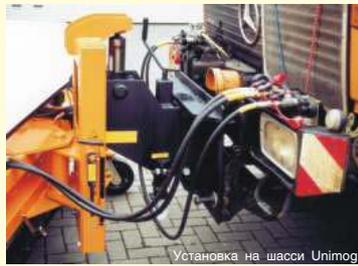
Установка на шасси Unimog
