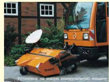
Установка на малую коммунальную машину
